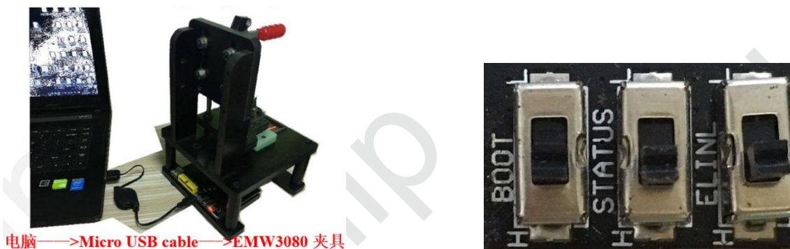
图 3.7 连接和设置 EMW3080 夹具
