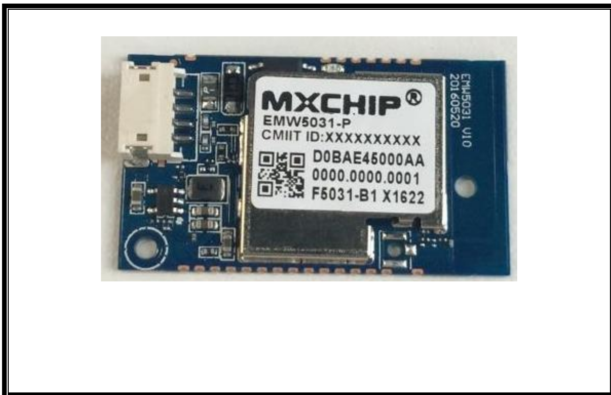
整体照 物理尺寸：长 X 宽 X 高=38mm(L)X 21.7mm(W)X 4.73mm(H)
