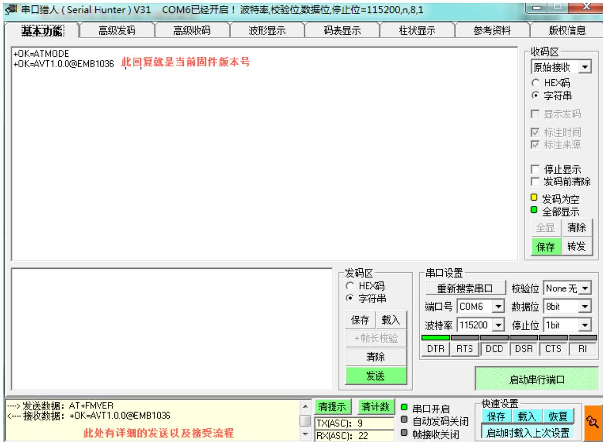
其它支持获取参数的指令都可以按照此流程进行，也可以通过 MCU 与此串口连接并发送接收相关信息。
