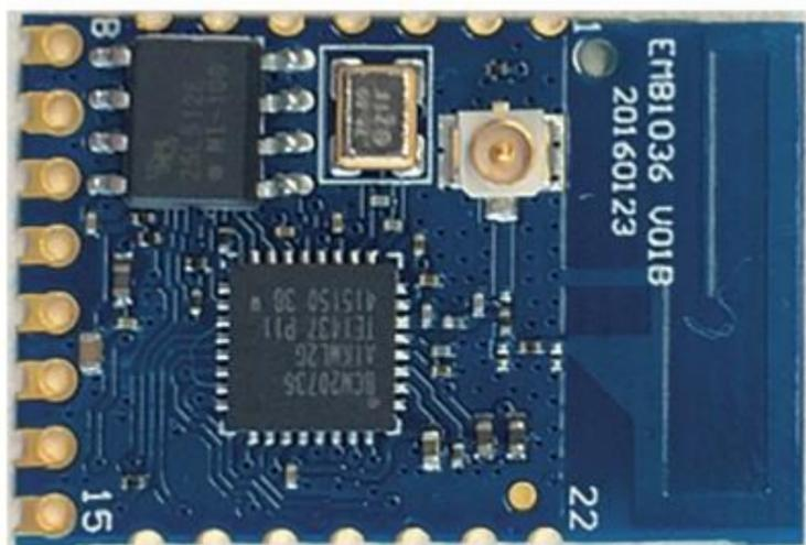
EMB1036是MXCHIP单芯片单模低功耗蓝牙模组，可以支持蓝牙Master以及Slave模式。在为用户提供完善的BLE功能的同时，也实现了超低功耗。
